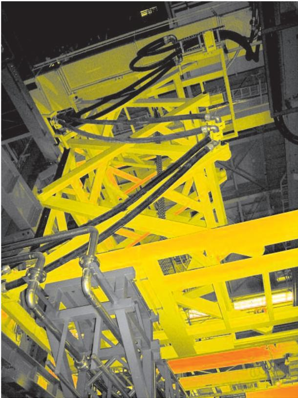
**Sistema di sollevamento a pantografo**
