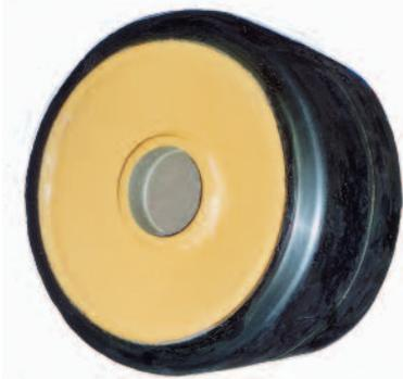
**NUCLEO** in acciaio elettrosaldato realizzato da un anello e da due o tre flange di adeguato spessore. **A richiesta** si realizza con un'unica flangia centrale di elevato spessore per montaggio su assali con freni.
