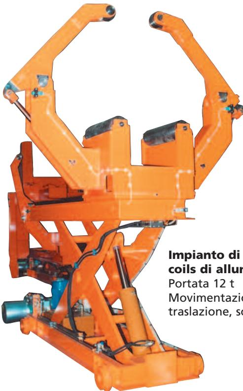
**Impianto di movimentazione coils di alluminio**
