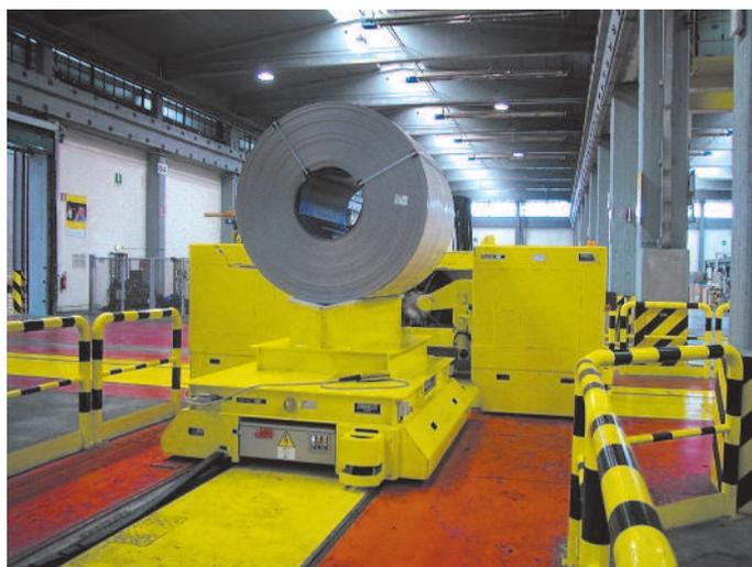
L'impianto in oggetto è in grado di movimentare coils, del peso max di 30 t, in modo completamente automatico (senza operatori al seguito dei carrelli). In particolare, la movimentazione automatica può avvenire dall'area di stoccaggio alle quattro linee di processo e viceversa e da una qualunque linea di processo a una qualunque altra.
