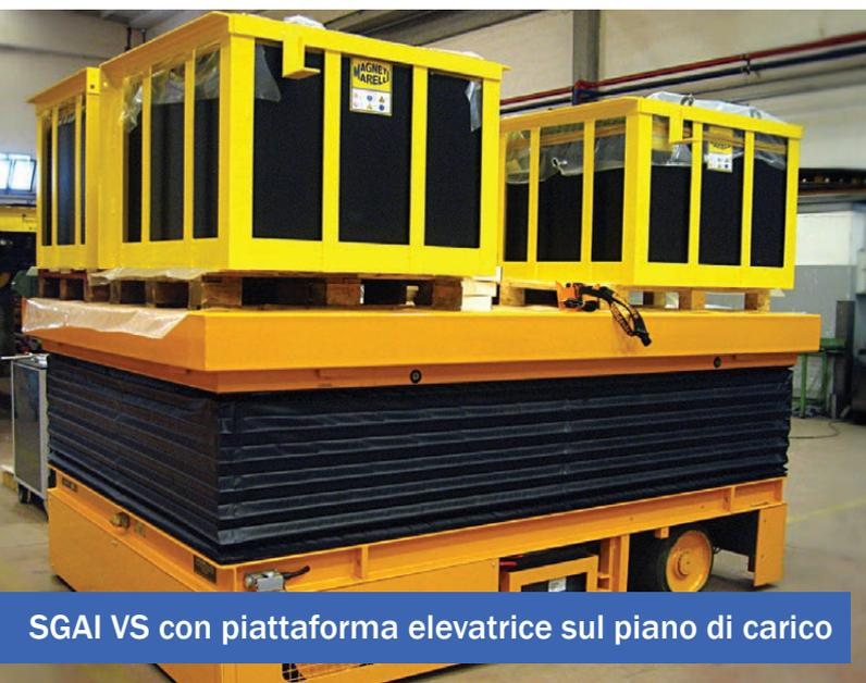
SGAI VS con piattaforma elevatrice sul piano di carico
